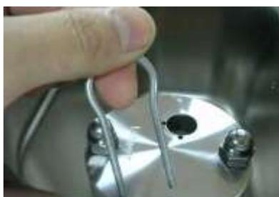
① バルブヘッドのロックンゲデバイスを抜きます。
